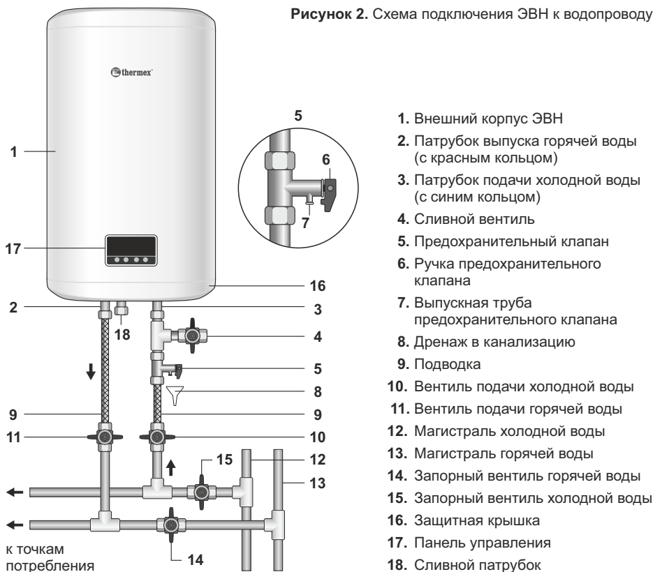
Рисунок 2. Схема подключения ЭВН к водопроводу
